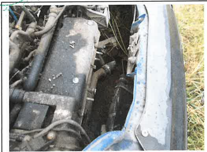
Fot.18. Brak elementów układu wydechowego
