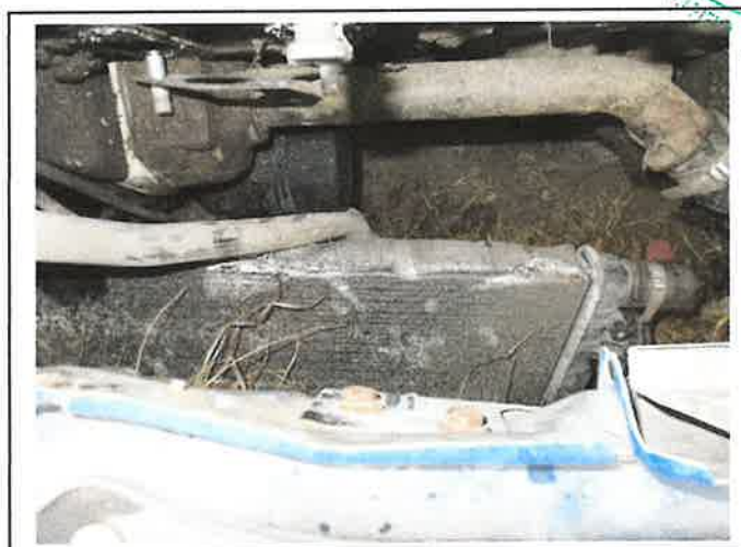
Fot.17. Uszkodzona chłodnica
