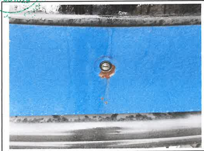
Fot.12. Uszkodzona pokrywa komory bagażnika
