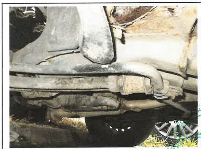
Fot.15. Uszkodzone/skorodowane podwozie
