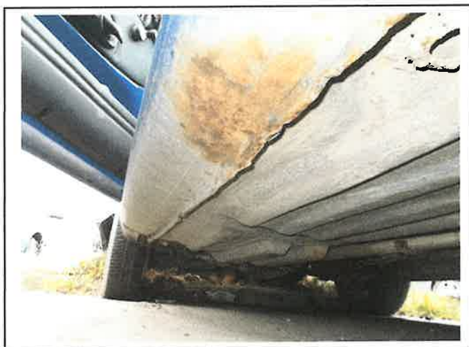
Fot.13. Uszkodzony próg L
