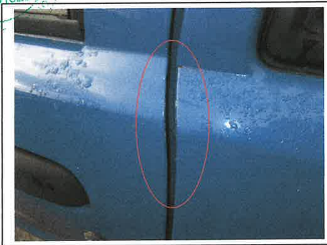
Fot.22. Uszkodzone drzwi L oraz błotnik TL
