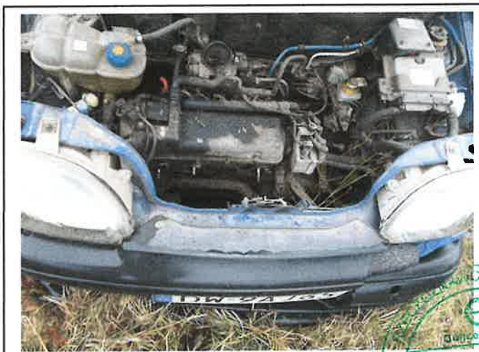
Fot.19. Brak elementów układu wydechowego
